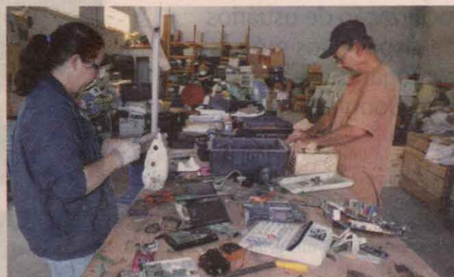
Funcionários retiram componentes de lixo eletrônico em uma empresa de processamento de Pato Branco
