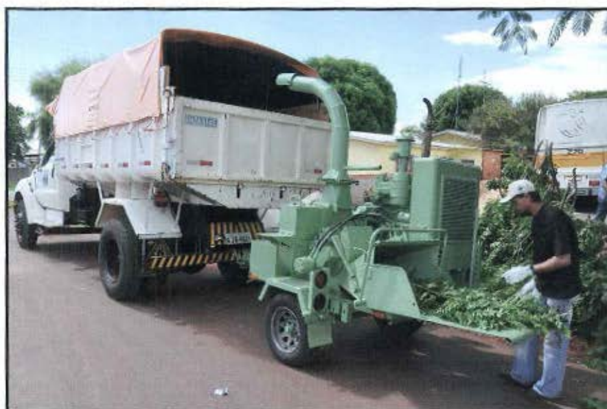
Figura – triturador de galhos acoplado a caminhão basculante
